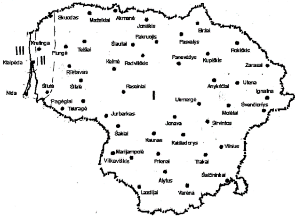
1 pav. Lietuvos vėjo apkrovos rajonai: I – v_{ref,0} = 24 m/s, II – v_{ref,0} = 28 m/s, III – v_{ref,0} = 32 m/s
